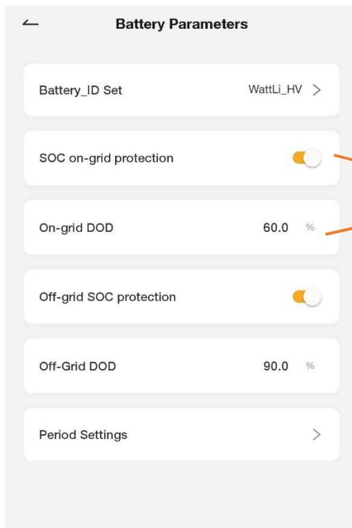
SOC on-grid protection muss eingeschaltet sein.
